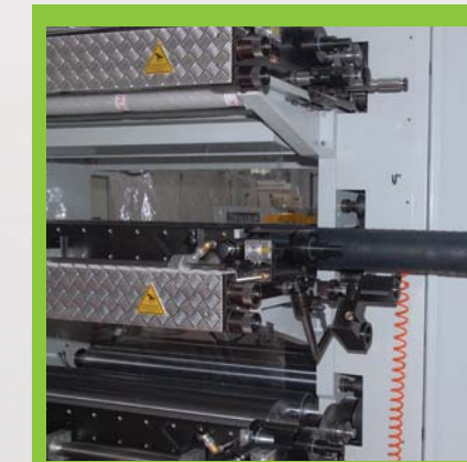
Dr. Chamber Blade and Sleeve System Printing Unit (Opt.) Kapalı Rakle ve Sleeve Sistem Flexo Baskı Ünitesi
